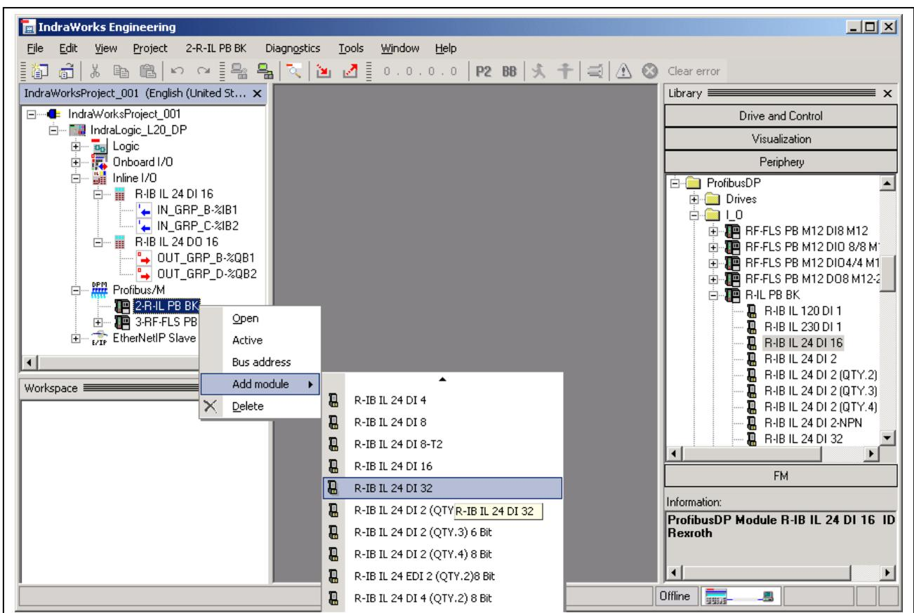
Fig. 4-32: Inserting a module
